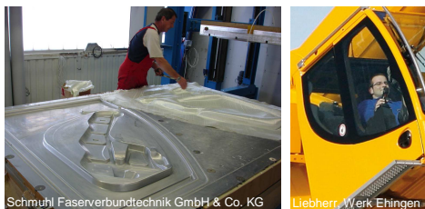
Herkömmliche Massivform für ein großes Kunststoffbauteil und Endprodukt (Kabinentür)
